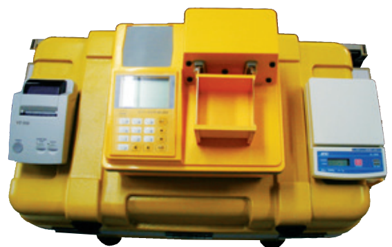
単位水量測定用器具(携帯型)
