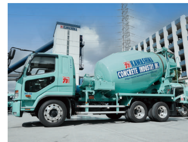
▲ 品質管理のため、工場とミキサー車のドラム部分に遮熱塗装を施している。
